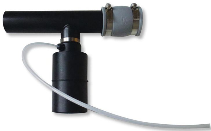
Billede 2: "Socket" til montering på drænudløb. Det vandrette rør monteres på udløbet. Sorbicellen sidder i den lodrette "beholder". Foto: Morten Palsgaard, Sorbisense A/S.
